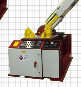
BAXTER SAW™- MODEL 500MV MITERING VERTICAL BANDSAW
